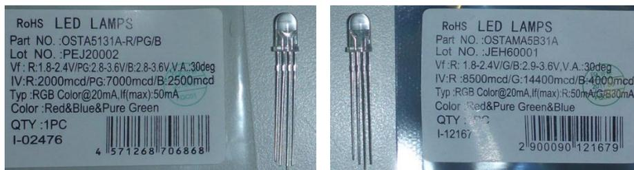
写真 4-1 RGB LED (左側：カソードコモン、右側：アノードコモン)
